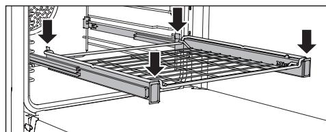
Нагрузка на направляющие FlexiClip составляет максимально 15 кг.
