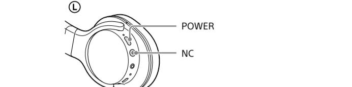
Pritisnite gumb POWER in ga držite približno 2 sekundi, če je enota izklopljena. Ko se enota in funkcija dušenja zunanjih zvokov vklipita, zasveti gumb NC. Način dušenja zunanjih zvokov je nastavljen na NC-način B.
