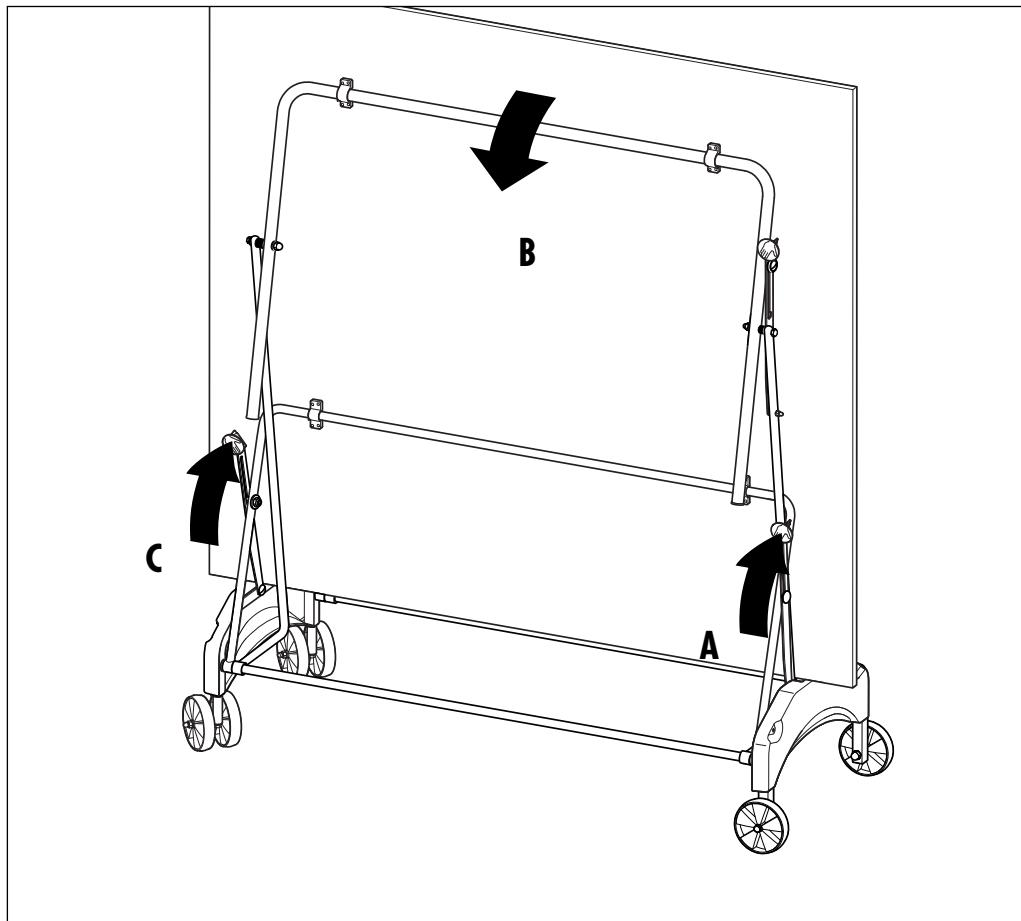
**D** Drücken Sie die rechte Kippsicherung. Anschließend die Platte mit einer Hand festhalten, linke Kippsicherung drücken und Platte langsam herunterklappen (Platte unter keinen Umständen einfach fallen lassen!).
