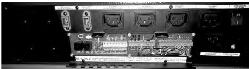
Рисунок 2 Клеммная колодка питания регулирующих устройств (пример внешнего вида колодки подключения питания, в зависимости от модели контроллера, установленного на котле).
