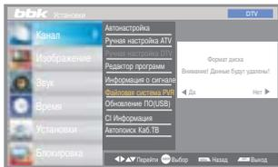
4. Если при форматировании выбран тип форматирования «Высокоскоростной FS», вы сможете изменить размер «ТаймШифт».
