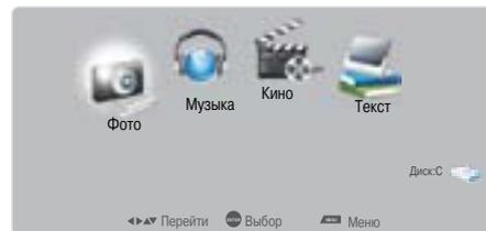
Нажмите ENTER, чтобы войти в меню выбора устройства. Выберите устройство клавишами **◀/▶** и нажмите ENTER. Будет отображен список файлов и папок. Для возврата к выбору типа мультимедиа нажмите «Назад». С помощью клавиш **◀/▶** и **▲/▼** выберите файл, на экране появится окно предварительного просмотра. Нажмите клавишу **▶II** для воспроизведения этого файла в полноэкранном режиме.
