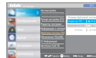
3. Пожалуйста, проверьте пункт «Поток». Если в пункте «Поток» установлено «Поддержка HD», скорости USB-устройства достаточно для выполнения функций «ТаймШифт» и «Запись». Если нет, то USB-устройство необходимо отформатировать. Обратите внимание, что при форматировании внешнего устройства все файлы и информация, хранящиеся на нем, будут стерты. После окончания форматирования подключенного устройства на экране отобразится меню.
