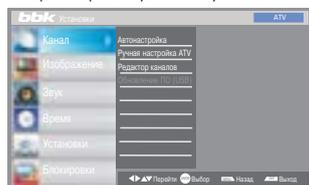
Автонастройка – позволяет выполнить автоматическую настройку каналов.
