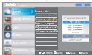
Ручная настройка ATV – позволяет вручную настроить аналоговые каналы.
