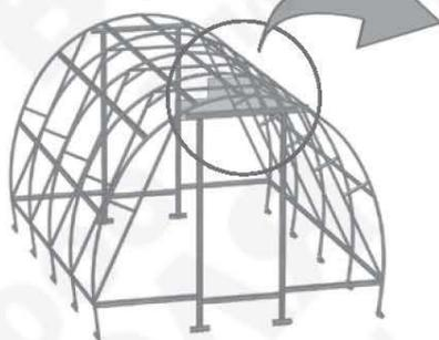
3. Установите боковины торца в соответствии с рис.24. Придерживая кусок покрытия, закрепите его винтами с шайбами по деталям 6к, 7, 8 (рис.16) и по уголкам с помощью самонарезных винтов с шайбами. Отверстия для винтов выполняются сверлом диаметром 5 мм изнутри теплицы через готовые отверстия в деталях каркаса. Установите куски «коньковой панели», закрепляя их на уголки с помощью самонарезного винта с шайбой. Нахлест с боковинами срезать.
