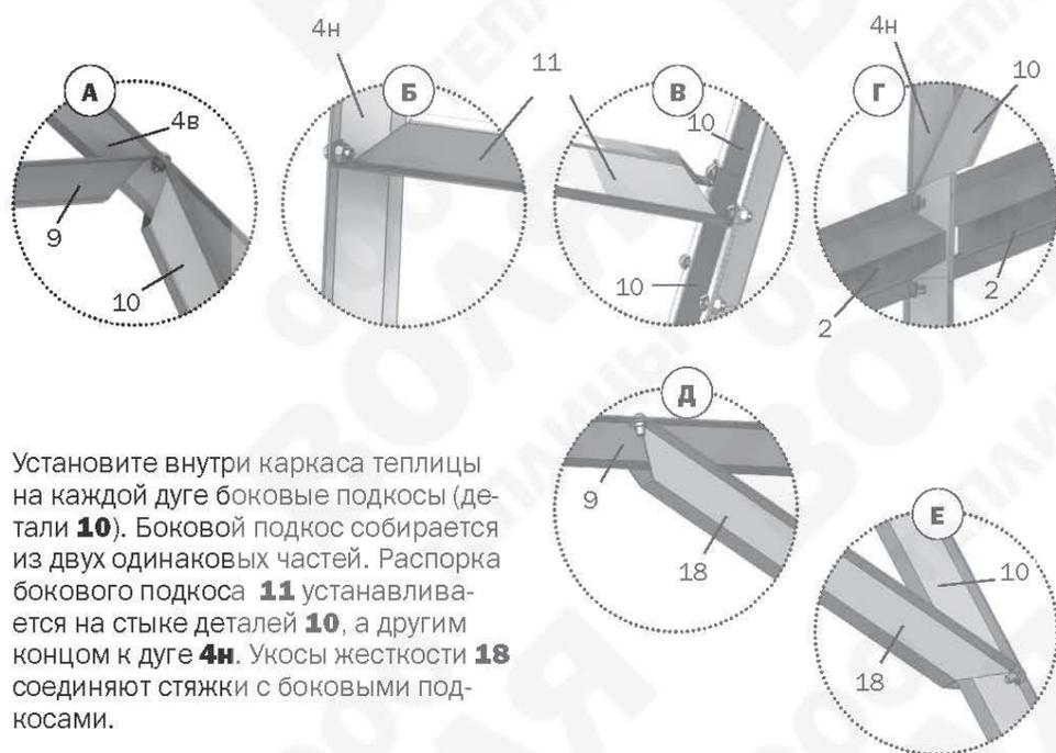
Установите внутри каркаса теплицы на каждой дуге боковые подкосы (детали **10**). Боковой подкос собирается из двух одинаковых частей. Распорка бокового подкоса **11** устанавливается на стыке деталей **10**, а другим концом к дуге **4н**. Укосы жесткости **18** соединяют стяжки с боковыми подкосами.
