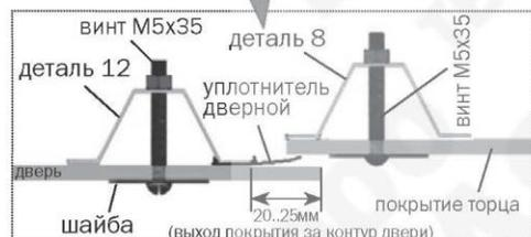
7. Установите собранные двери и форточки на торцы, устанавливая уплотнитель в соответствии с рис.20-23. При навеске форточек необходимо избежать ее дальнейшее возможное провисание. При затяжке винтов приподнять противоположный край форточки, чтобы выбрать зазоры винтов в отверстиях.
