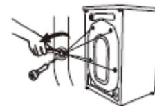
1. Ослабьте 4 болта гаечным ключом и снимите их.
