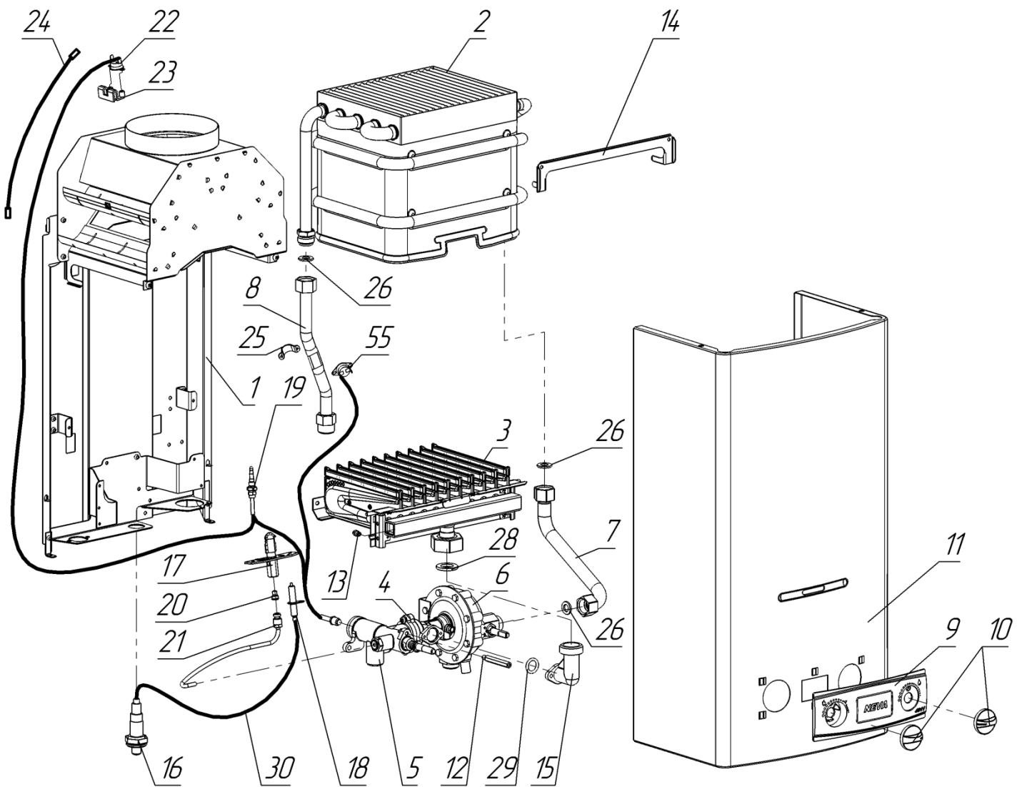
Рисунок 15. Вид аппарата «NEVALUX-5111» с разнесёнными частями
