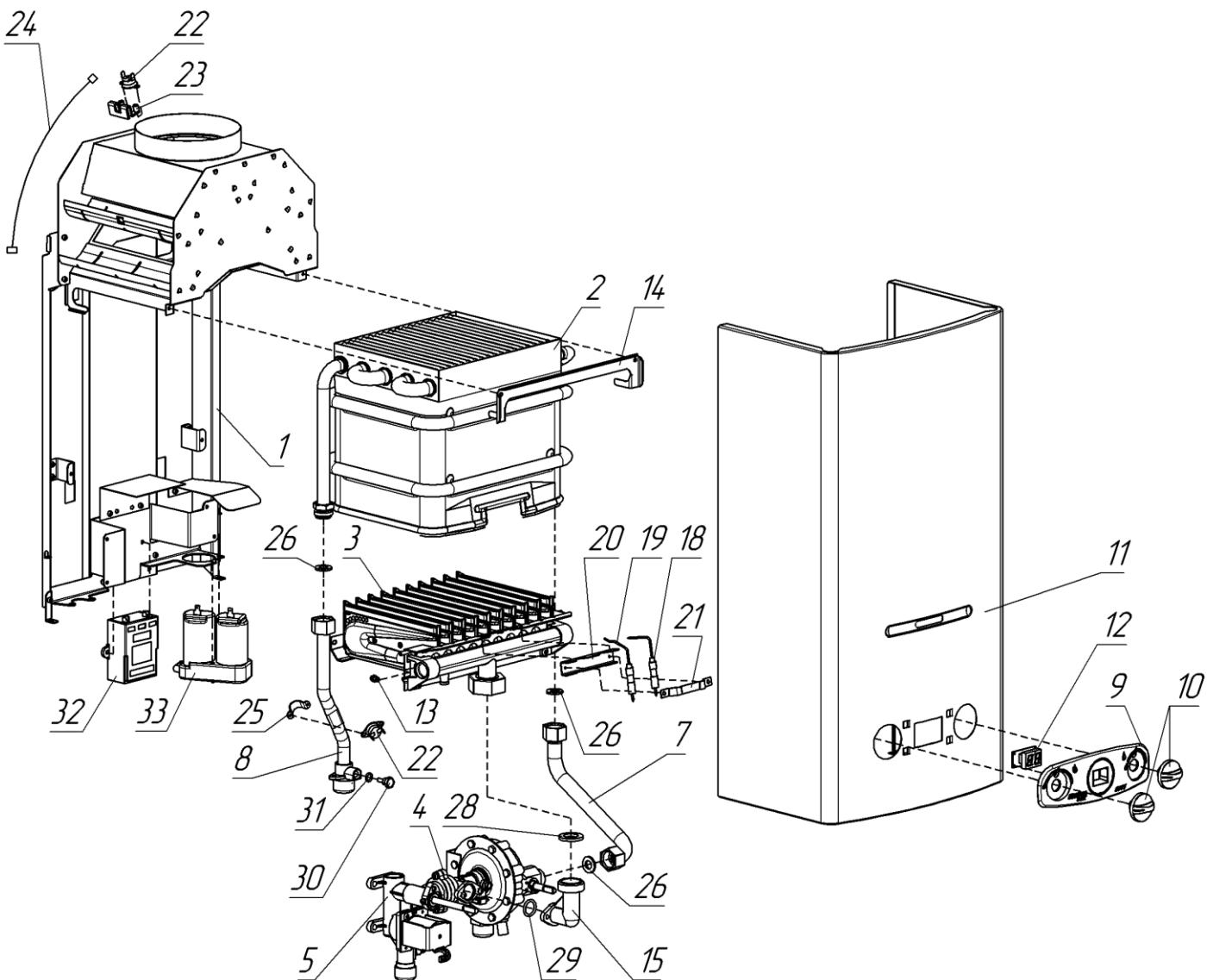
Рисунок 17. Вид аппарата «NEVALUX-5611» с разнесёнными частями
