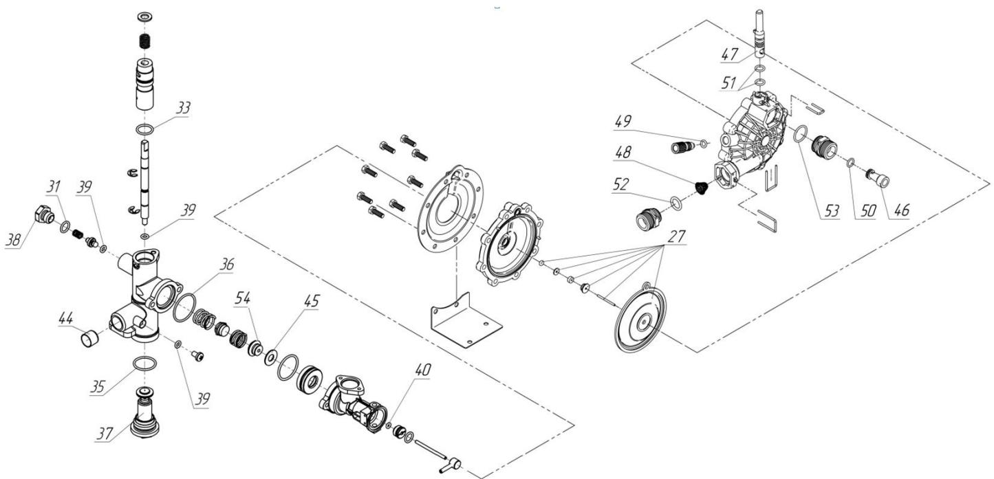
Рисунок 16. Составные части узла водогазового 3251-02.400
