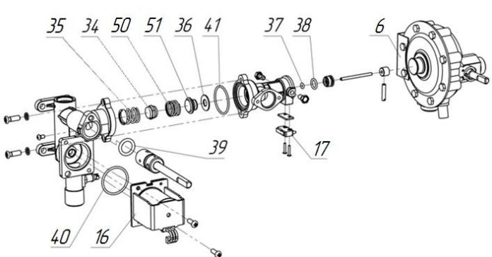
Рисунок 18. Составные части узла водогазового 3275-02.200
