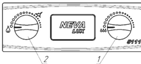
а) Ручки регулировки расхода воды 1 и расхода газа 2 в положении
