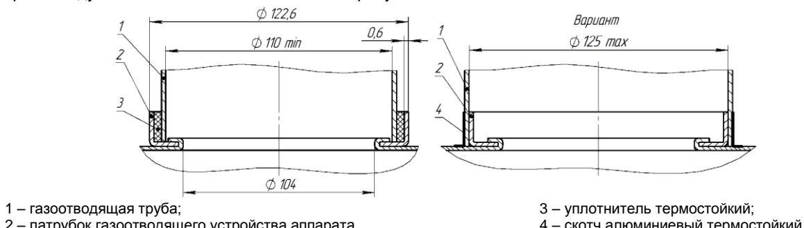
Рисунок 9. Схема подсоединения газоотводящей трубы
