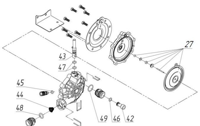
Рисунок 19. Составные части узла водяного STG-W4P1
