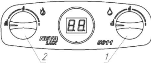
а) Ручки регулировки расхода воды 1 и расхода газа 2 в положении
