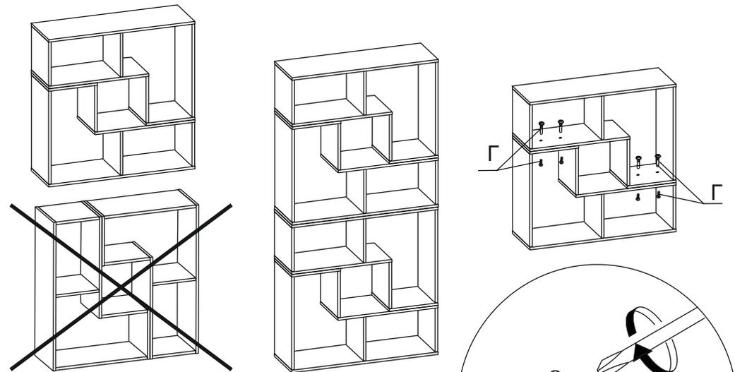
3.5. В целях безопасности рекомендуется закрепить конструкцию к стене при помощи монтажного уголка (поз.Е), И прилагаемых шурупов 4x16 и 4x40. Предварительно просверлив в стене отверстие диаметром 6 мм и забив туда пластиковый дюбель.
