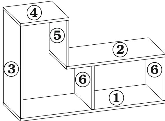
3.2. В Основание (дет.№1) и полку (дет.№2), вкрутите штоки эксцентрики (поз.В). В перегородки (дет.№6) и боковину (дет.№3) установите эксцентрики (поз.Б). Соедините детали, так чтобы штоки эксцентриков вошли в торцевые отверстия. Зафиксируйте эксцентрики повернув их на 180 градусов по часовой стрелке.
