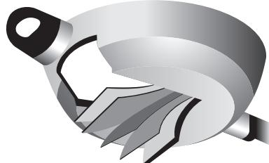
Днище посуды для индукционных плит либо целиком выполнено из ферромагнитного сплава, либо имеет несколько внутренних слоев такого материала.
