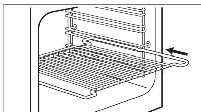
Вставьте полку между направляющими планками духового шкафа. Двусторонние кромки должны быть расположены в задней части духового шкафа по направлению вверх.
