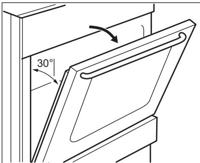
2. Возмитесь за дверную планку (B) на верхней кромке дверцы с обеих сторон и нажмите внутрь, чтобы освободить защелку.
