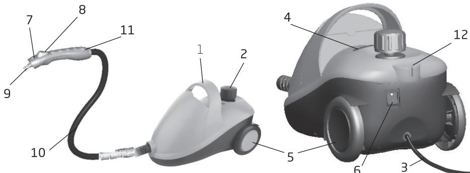
В держатель для принадлежностей (12) можно вложить насадку с подсоединенными к ней паровым шлангом или удлинительной трубкой. Также на него надевается держатель кабеля питания, на который вы можете сматывать шнур электропитания.
